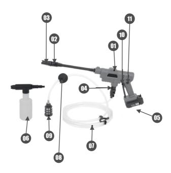
**HIGH PRESSURE WASHER PARTS POSITION / UBICACIÓN DE LOS COMPONENTES DE LAVADORA DE ALTA PRESION /** LOCALIZAÇÃO DOS COMPONENTES DA LAVADORA DE ALTA PRESSÃO
