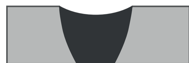
Excesso de penetração (BURN THROUGH)
