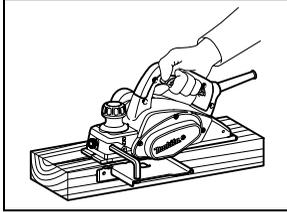
Ao fazer o aplainamento, mova a ferramenta com a guia de borda rente com a lateral da peça de trabalho. Caso contrário poderá resultar em aplainamento imperfeito. A profundidade de desbaste (entalhe) máxima é de 9 mm.
