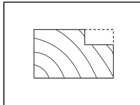
Para fazer um corte escalonado como indicado na ilustração, use a guia de bordas (régua guia) obtida como acessório.
