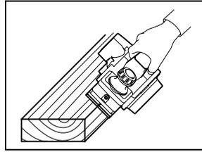
Ajuste a guia de borda até que faça contato com a lateral da peça de trabalho, depois prenda-a apertando o parafuso.
